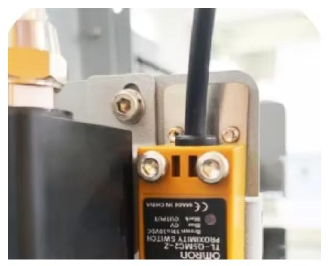
Automatischer Höhensensor bis 150 mm
