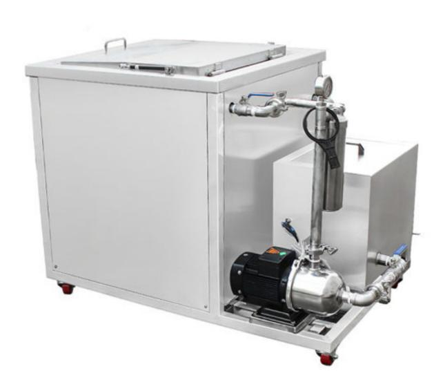
Es besteht aus Edelstahl und wird von Hand mit Argon geschweißt, was eine unglaubliche Haltbarkeit während des Gebrauchs gewährleistet.
