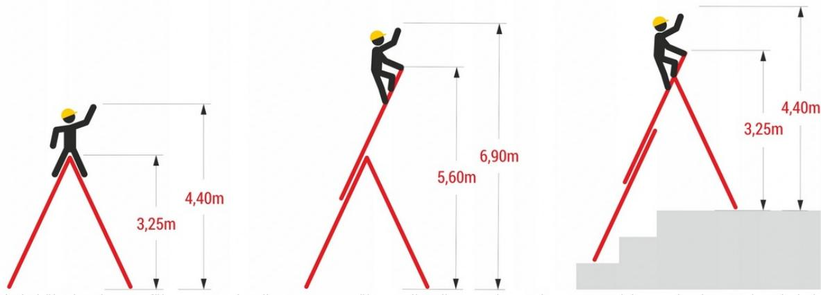
Die Arbeitshöhe ist ein ungefährer Wert, der die erwartete Höhe angibt, die von einer Leiter aus erreicht werden kann. Die Arbeitshöhe zeigt die mögliche Reichweite einer gegebenen Leiter an und ist ein Richtwert, der von den meisten Herstellern verwendet wird.
