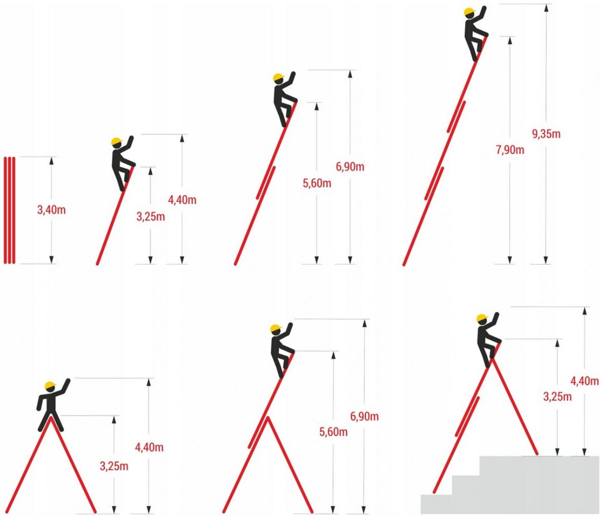
Die Arbeitshöhe ist ein ungefährer Wert, der die erwartete Höhe angibt, die von einer Leiter aus erreicht werden kann. Die Arbeitshöhe zeigt die mögliche Reichweite einer gegebenen Leiter an und ist ein Richtwert, der von den meisten Herstellern verwendet wird.
