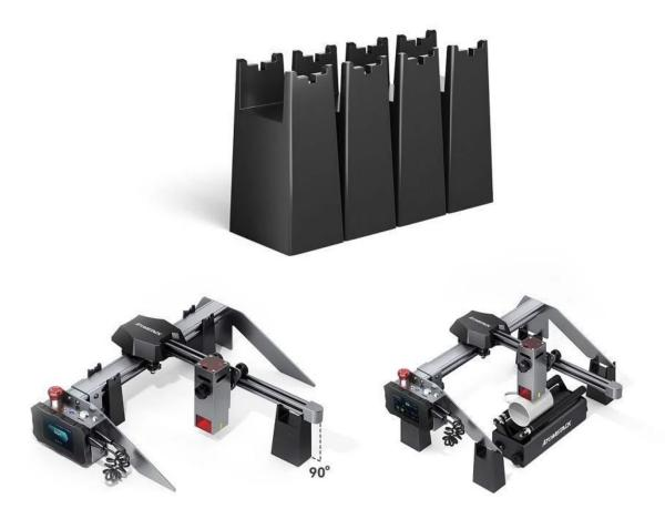
Im Lieferumfang der Gravurmaschine befinden sich 4 stabilisierende Stützen – für die ideale Ausrichtung der Gravurmaschine in Bezug auf das Material. Sie helfen auch beim Gravieren mit einem rotierenden Aufsatz, indem sie die Höhe erhöhen.
