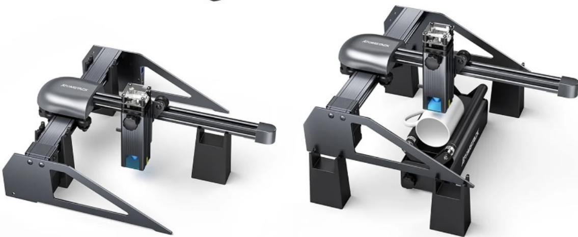
**Die Lasergraviermaschine P7 M30 ist mit vielen Betriebssystemen kompatibel** - (LightBurn-Programm, Laser GRBL): WinXp, Win7, Win8, Win10, sowie mit Mac (LightBurn-Programm), Es unterstützt auch viele Dateiformate: NC, BMP, JPG, PNG, DXF, etc.
