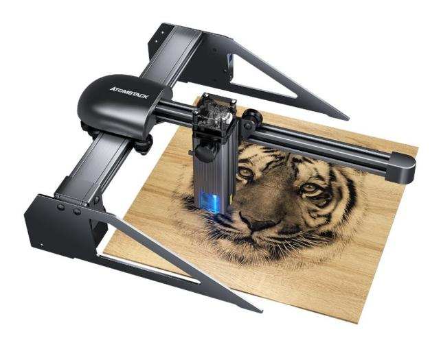
**Im Lieferumfang des Gravierers sind 4 Stabilisierungsstützen enthalten -** für eine perfekte Positionierung des Gravierers im Verhältnis zum Material. Sie helfen auch, wenn Sie mit dem Drehaufsatz gravieren möchten, wir erhöhen dann die Höhe.
