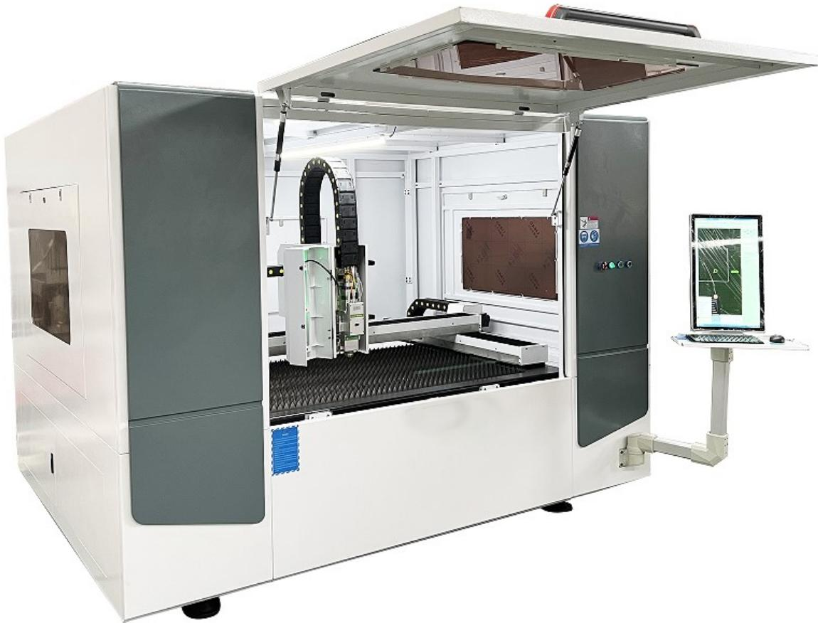
Alle Komponenten des Lasers sind in einem geschlossenen Gehäuse untergebracht, was ein hohes Maß an Sicherheit für die Bediener und Sauberkeit am Arbeitsplatz gewährleistet.
