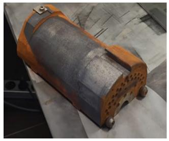
Es handelt sich um das **Oberflächenreinigungsgerät der neuesten Generation.** Reinigt Objekte gründlich – ideal zum Reinigen von **Farben, Ölen, Schmutz, Rost, Anlauffarben, Harz usw.** Der Laser wird überall dort eingesetzt, wo herkömmliche Reinigungstechniken versagen.
