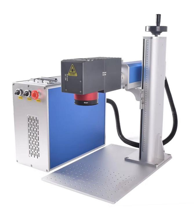
Dank des **3D-Technologie-Kopfes** können Sie tief in unregelmäßig geformten Objekten lasern, wie Kugeln, gewölbte Oberflächen, Ringe, zylindrische Objekte und viele andere unregelmäßige Formen, mit denen normale 2D Faserlaser-Gravierer nicht zurechtkommen.
